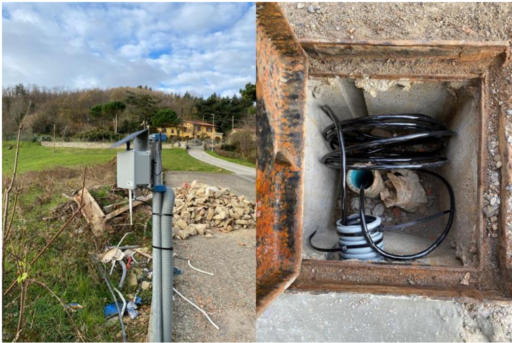
Figura 11 - A destra sensore piezometrico installato nel sondaggio P2 e del relativo nodo (a sinistra).
