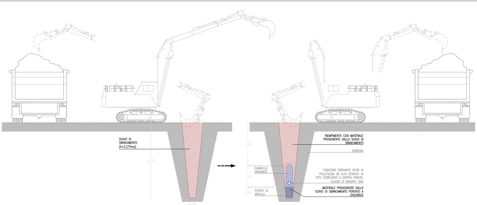
a) ESECUZIONE SCAVO DELLA TRINCEA DI ALLOGGIAMENTO
