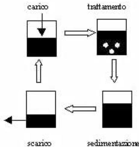
Fig. 11 – Schema di processo reattore SBR (Sequencing Batch Reactor)
