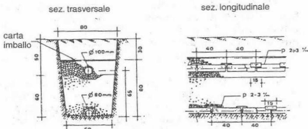
Fig. 7 – Impianto di sub-irrigazione drenata
