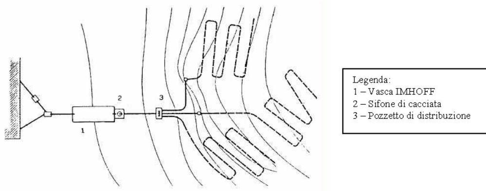
Fig. 5 – Andamento planimetrico delle condotte di sub-irrigazione
